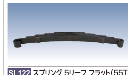
SL122 スプリング 5リーフ フラット(55T) サイズ:69×12×4×63cm(長さ×高さ×幅×取付ピッチ) 品番 4610073 (1ヶ)¥13,020 ¥12,400
