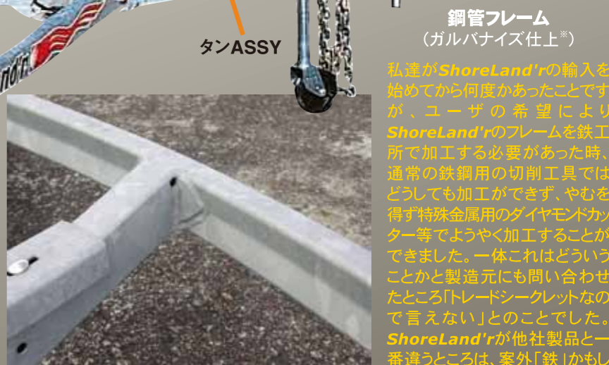
鋼管フレーム (ガルバニイズ仕上*) タンASSY ※ガルバニイズ (溶融亜鉛めっき) 仕上フレーム 鉄の表面仕上げ法としては最も歴史が古い方法で、傷が付いたりしてめっきが部分的に破壊されたりしても自己修復作用があるため、過酷な使用環境下でも優れた耐久性を発揮します。
